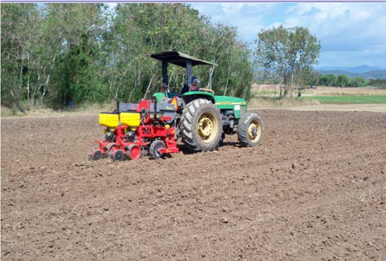
Una sembradora mecánica es muy útil para la siembra de mucuna en predios más grandes.
